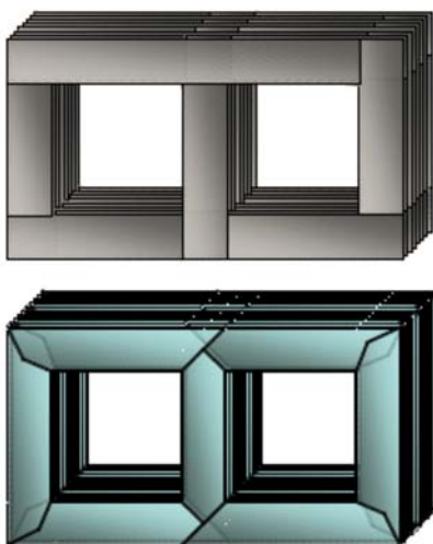
Figura 3.1 - Exemplo de Transformadores com Núcleo Laminado à 90^\circ (figura superior) e laminado à 45^\circ
