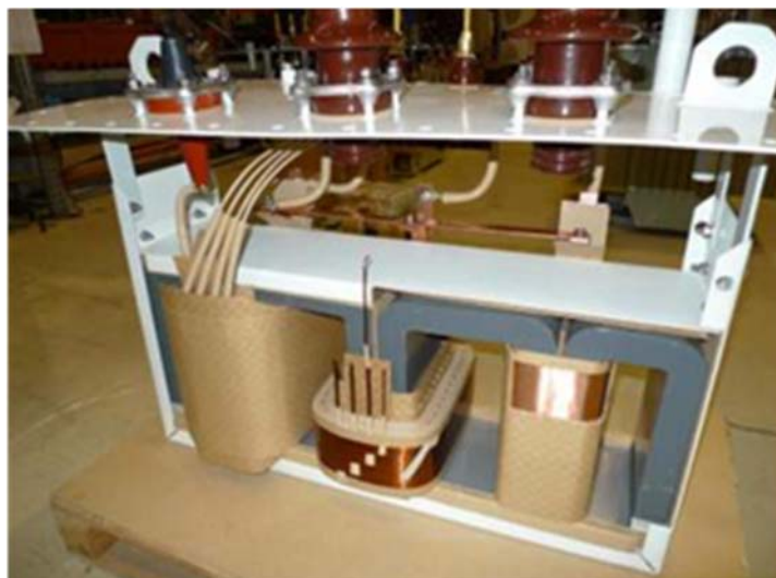
Figura 3.6 - Exemplo de Construção de Transformador Trifásico com Núcleo Amorfo
